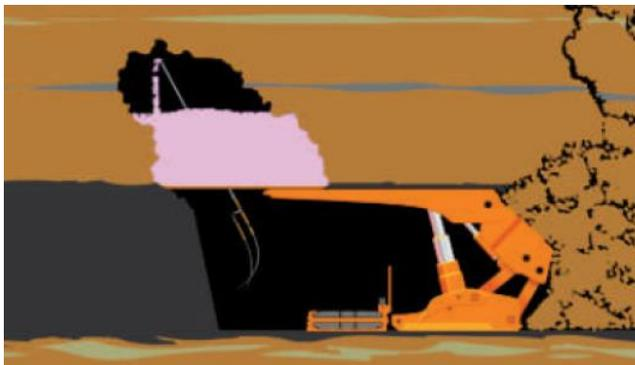
**Фенольная смола Экофлекс** состоит из двух жидких компонентов (смола и катализатор), которые в объемном соотношении 4:1 при помощи специального насоса прокачиваются отдельно по шлангам, перемешиваются в смесителе и подаются в заполняемую пустоту. После выхода из смесителя компоненты немедленно реагируют с увеличением объема и создают пенную массу.
